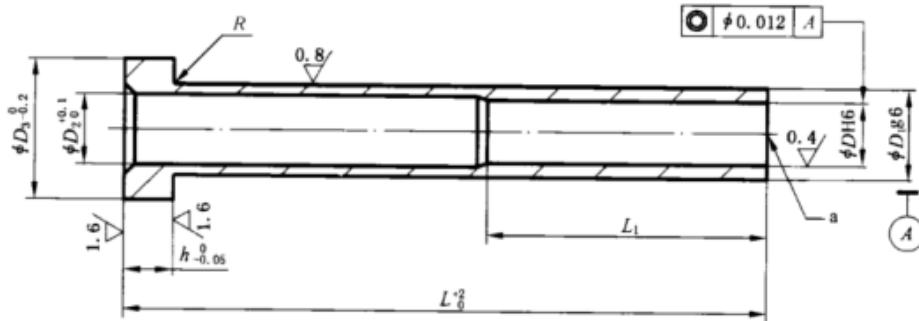
未注表面粗糙度  $R_a = 6.3 \mu\text{m}$ ；未注倒角  $1 \text{ mm} \times 45^\circ$ 。
